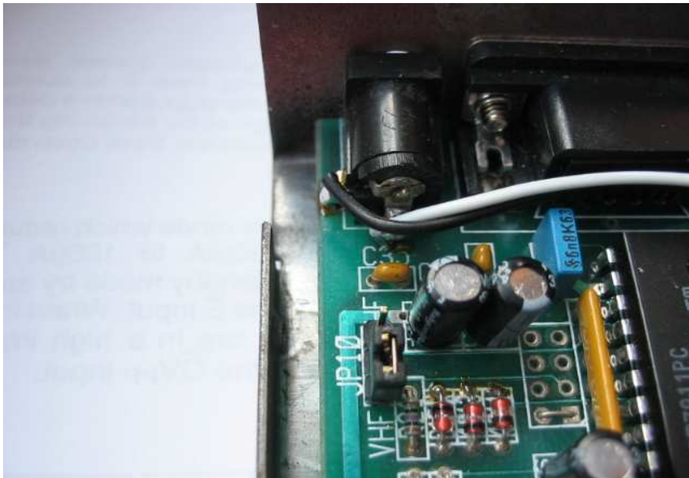
Miejsce podłączenia zasilania WATCHDOGA
